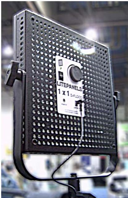
Die Panels sind für 5600 K in Flood- oder Spot-Ausführung, für 3200 K jedoch lediglich in einer Flood-Ausführung lieferbar. Der Nettopreis beträgt rund 2.000 US-Dollar pro Panel.
