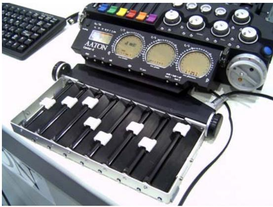
erweitert Aaton mit dem Reglermodul CantaRem dessen Funktionsumfang. Dieses Modul besteht im wesentlichen aus acht Schieberegler, die sich mittels CantarX-Software beliebig den internen Input- und Output-Fadern
