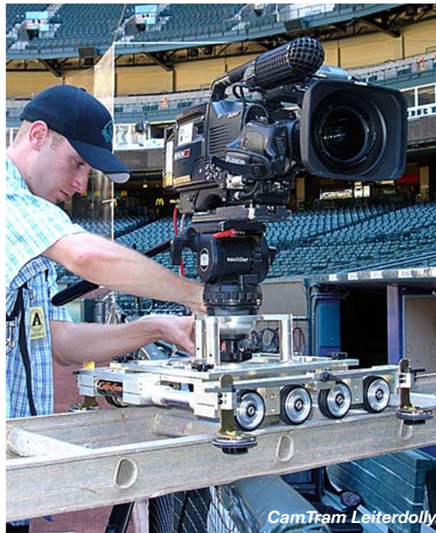
skopachsen auf unterschiedliche Breiten eingestellt werden, es genügt eine einfache glatte Unterlage wie etwa eine Alu- oder Holzleiter, ein Balken, Tisch oder ähnliches, um platzsparend gerade Kamerafahrten zu realisieren.
