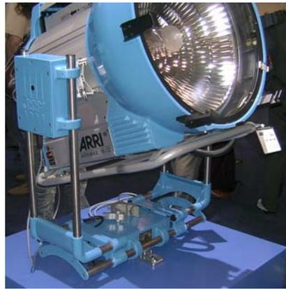
Die Steuerung für Pan, Tilt und Fokus erfolgt über DMX512, die maximale Fahrgeschwindigkeit wird mit 360 Grad/min, die minimale mit 12,6 Grad/min angegeben. Der Fokusantrieb liefert eine maximale Drehzahl von 16 U/min.
