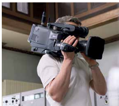
Broadcast-Kamera mit eingebautem 5G-Modem.
